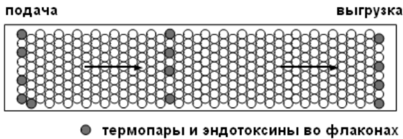
Рисунок 4 – Пример размещения температурных датчиков внутри флаконов при изучении проникания тепла в стерилизационном/депирогенизационном туннеле
