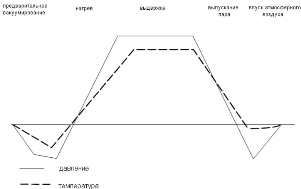
Рисунок А.2 – Диаграмма типичного цикла с использованием стадии предварительного вакуумирования
