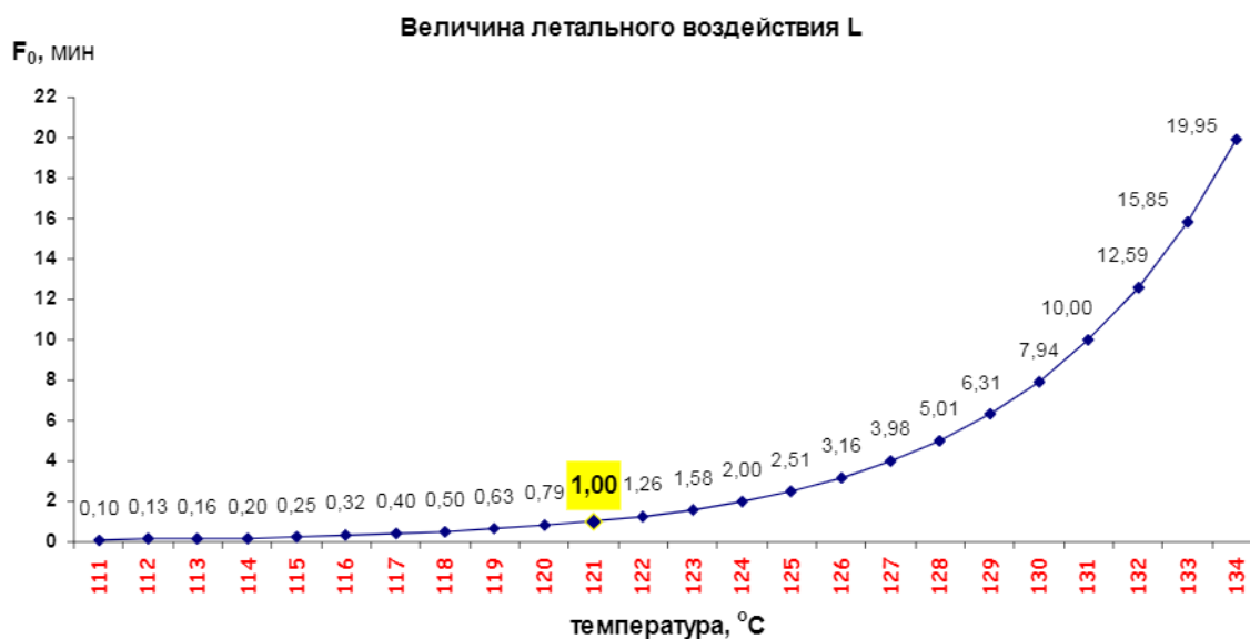
Рисунок 2 – Относительная величина летального воздействия на биоагрузку/биоиндикатор при разной температуре по отношению к величине F 0 (F 121 10 )
