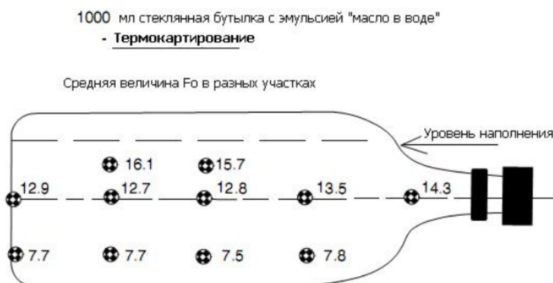
Рисунок 1 – Пример определения наименее прогреваемых зон в стеклянном контейнере с модельной жидкостью в горизонтальном положении («термокартирование») [6]
