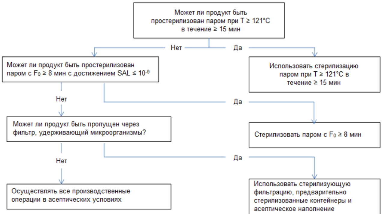
Рисунок 1 – Схема принятия решений для продуктов на водной основе
